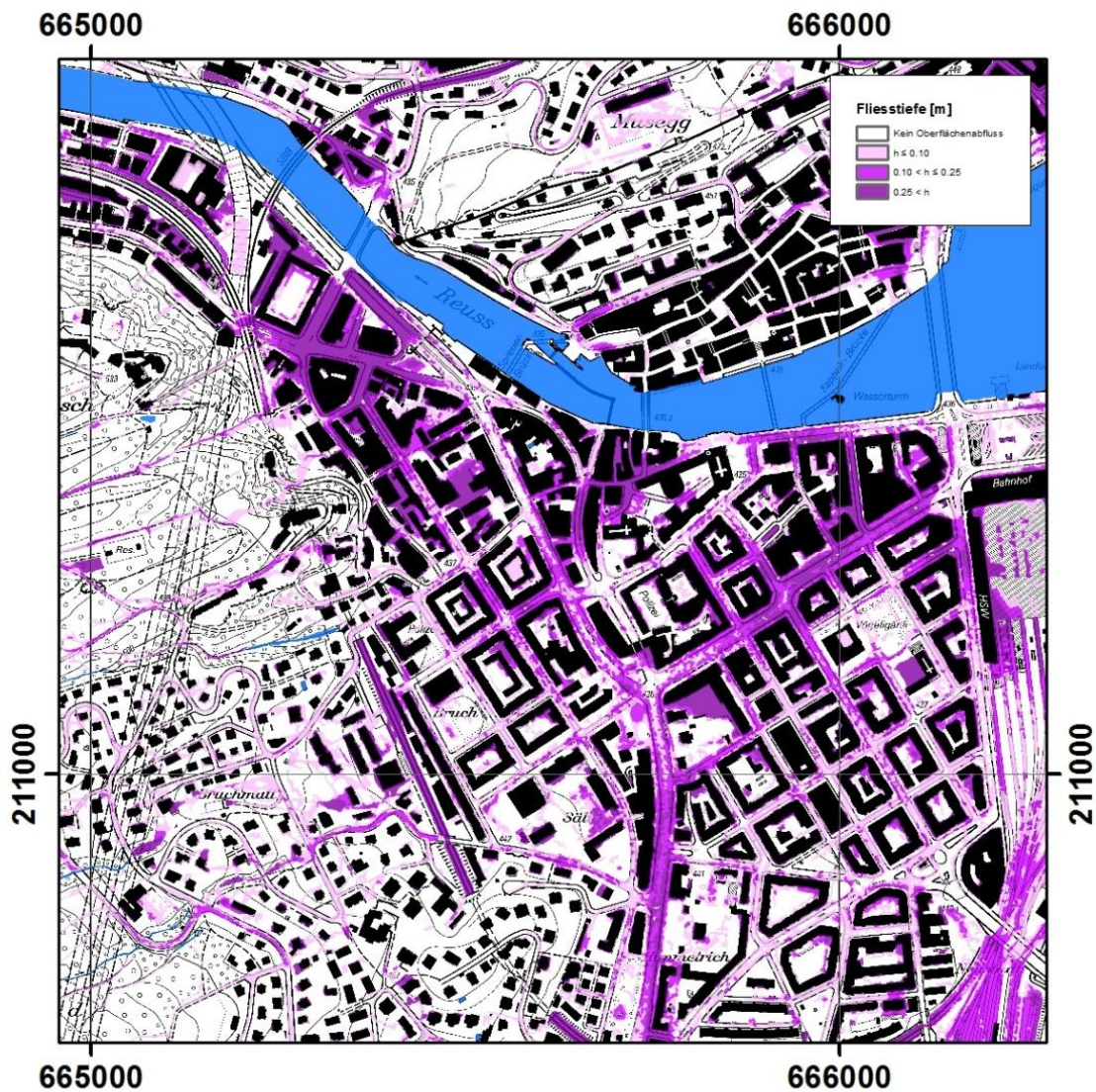
Abbildung 14: In Siedlungszentren ist die Genauigkeit der Oberflächenabflusskarte limitiert. Bei der Modellierung wurde die Siedlungsentwässerung nicht berücksichtigt. (Kartenhintergrund: UP10 © GIS Kanton Luzern).
