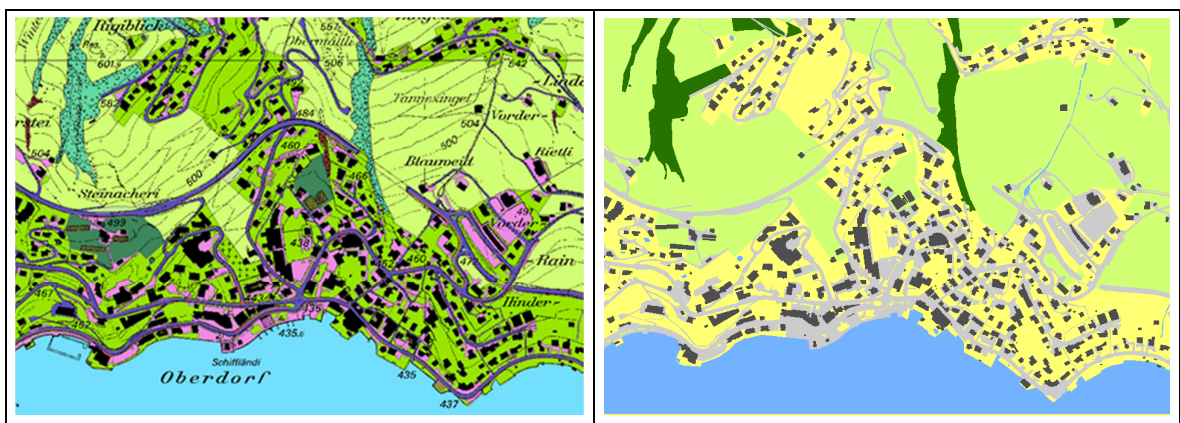
Abbildung 6: Übersichtsplan UP10 mit den eingefärbten Klassen der AV-Bodenbedeckung (links) und der Modellinput für die Bodenbedeckung (rechts) des Gebietes Weggis Oberdorf. Legende der Bodenbedeckungskarte: dunkel grau = Gebäude, hellgrau = befestigte Flächen, hellgrün = Landwirtschaftsland, gelb = Garten / Hausumschwung, blau = Gewässer, dunkelgrün = Wald. (Kartenhintergrund: UP10 © GIS Kanton Luzern).
