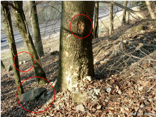
Foto R17: Steiler Hang unterhalb Felswand W' Muffehus Baumtreffer. Die meisten Steine und Blöcke des Ausbruchs sind auf der Transitstrecke liegen geblieben
