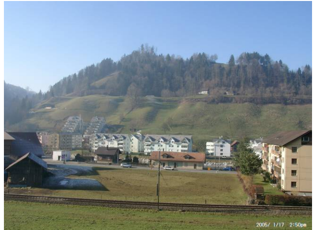
Foto Wo2: Kommetsrüti Die bucklige Morphologie oberhalb Kommetsrüti weist auf Rutschanfälligkeit hin (Spontanrutschungen / Hangmuren).
